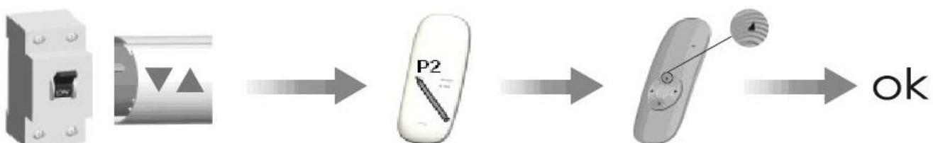
Dare alimentazione – il motore emetterà 1 beep lungo, e una breve rotazione nei due sensi di UP/DOWN (apertura/chiusura)
