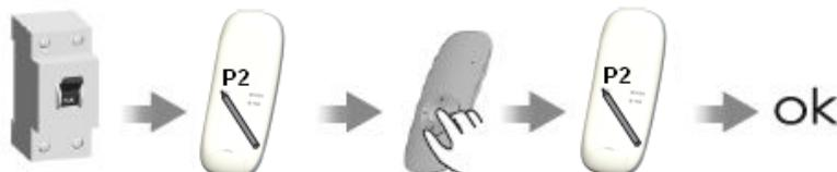
Motore alimentato – Fare una breve manovra di apertura/chiusura e Stop – Premere una volta il tasto P2, una volta il tasto Stop e un'altra volta il tasto P2. Ad ogni pressione il motore emetterà 1 beep e breve manovra.
