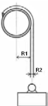
$$\text{PESO} = \frac{\text{Coppia nominale motore (Nm)}}{\text{Leva di sollevamento (Nm)}}$$
