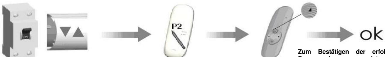
Stromversorgung einschalten – Der Motor sendet einen langen Beep-Ton, und dreht sich kurz in die beiden Richtungen UP/DOWN (Öffnen/Schließen).
