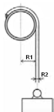
$$\text{POIDS} = \frac{\text{Couple nominale moteur (Nm)}}{\text{Levier de levage (Nm)}}$$
