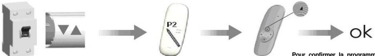
Interrupteur sur ON – Le moteur émet 1 bip sonore long et une brève rotation dans les deux sens UP/DOWN (ouverture/fermeture).
