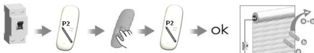
Motor alimentado – Pulsar una vez la tecla P2, una vez la tecla Stop y otra vez la tecla P2. El motor NO emite ningún bip. Cada vez que presione, el motor emitirá 1 pitido y una maniobra corta.
