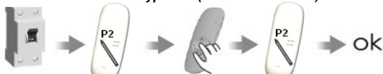
Versorger Motor – Einschalten - Kurzen Öffnungs-, Schließ- und STOP-Vorgang durchführen - Einmal die Taste P2, einmal die Taste Stop und ein weiteres Mal die Taste P2 betätigen. Der Motor sendet KEINEN Beep-Ton aus.
