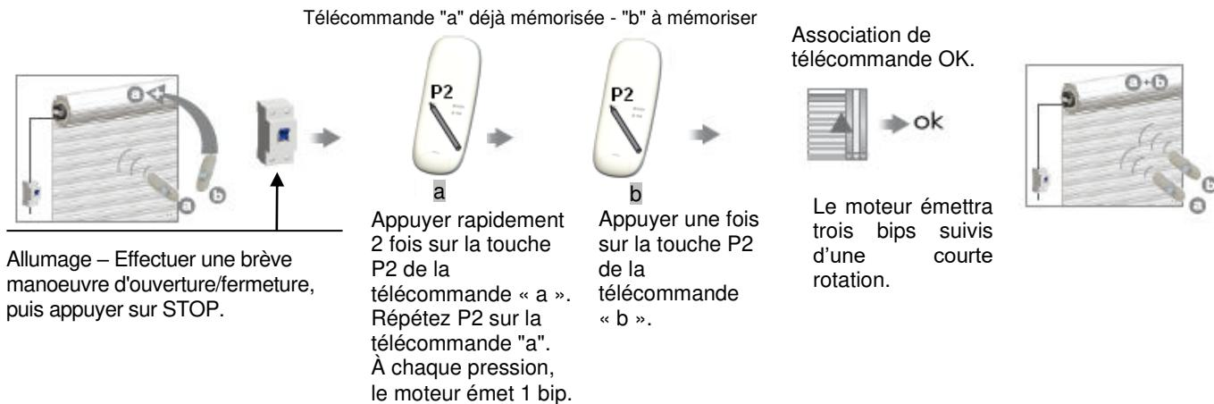
**!** Le temps minimal nécessaire de l'allumage est de 5 s. Si l'alimentation a été coupée puis rétablie, il sera nécessaire d'exécuter une commande UP/DOWN avant de procéder à l'effacement.
