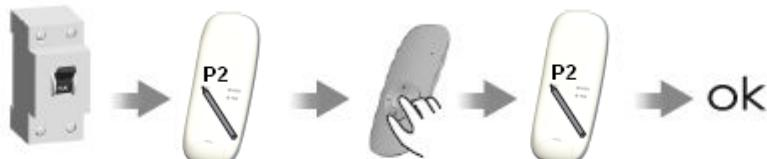
Moteur alimenté – Effectuer une brève manoeuvre d'ouverture/fermeture, puis appuyer sur STOP - Appuyer une fois sur la touche P2, une fois sur la touche Stop et une fois encore sur la touche P2. Le moteur n'émettra PAS de bip sonore. À chaque pression, le moteur émet 1 bip et une
