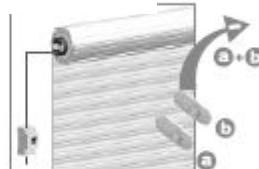
Zum Bestätigen des erfolgten Löschens sendet der Motor 3 Beep töne gefolgt von einer kurzen Drehung in die beiden Richtungen UP/DOWN aus (Öffnen/Schließen).
