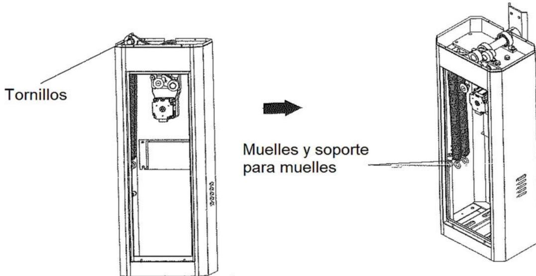
**Paso 2:** Utilizando la palanca de desbloqueo manual, dirigir el soporte del mástil a la posición horizontal o cerrada.
